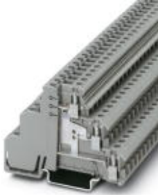
Initiatoren-/Aktorenklemme, Querschnitt: 0,2 mm 2 - 4 mm 2 , AWG: 24 - 12, Anschlussart: Schraubanschluss, Breite: 6,2 mm, Farbe: grau, Montageart: NS 35/7,5, NS 35/15
