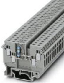
Durchgangsklemme, Anschlussart: Schraubanschluss, Querschnitt: 0,2 mm<sup>2</sup> - 6 mm<sup>2</sup>, AWG: 24 - 10, Breite: 6,2 mm, Farbe: grau, Montageart: NS 35/7,5, NS 35/15, NS 32
