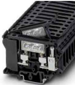
Sicherungsklemme für G-Sicherungseinsatz, Querschnitt: 0,5 - 16 mm 2 , AWG: 26 - 8, Breite: 10,2 mm, Farbe: schwarz
