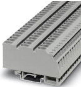
Durchgangsklemme, Anschlussart: Schraub- / Steckanschluss, Polzahl: 1, Querschnitt: 0,2 mm 2 - 4 mm 2 , AWG: 24 - 12, Breite: 7,62 mm, Farbe: grau, Montageart: NS 32, NS 35/7,5, NS 35/15
