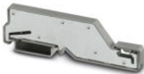
Auflagebock, Halterung für Sammelschienen, alle 20 cm zu setzen, Länge: 95,5 mm, Breite: 6,2 mm, Farbe: grau
