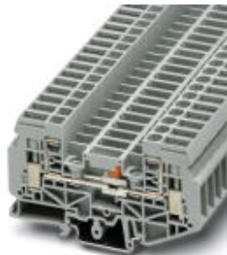
Messwandler-Trennklemme, Anschlussart: Schraubanschluss, Querschnitt: 0,5 mm 2 - 10 mm 2 , AWG: 20 - 10, Breite: 8,2 mm, Montageart: NS 35/7,5, NS 35/15, NS 32, Farbe: grau
