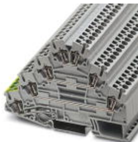
Durchgangsklemme, Anschlussart: Zugfederanschluss, Querschnitt: 0,08 mm 2 - 4 mm 2 , AWG: 28 - 12, Breite: 5,2 mm, Farbe: grau, Montageart: NS 35/7,5, NS 35/15
