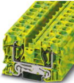
Zugfeder-Schutzleiterklemme, Anschlussart: Zugfederanschluss, Querschnitt: 0,2 mm 2 - 25 mm 2 , AWG: 24 - 4, Breite: 12,2 mm, Farbe: grün-gelb, Montageart: NS 35/7,5, NS 35/15
