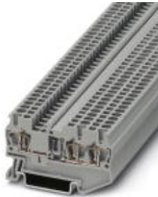
Bauelementreihenklemme, Anschlussart: Zugfederanschluss, Querschnitt: 0,08 mm 2 - 4 mm 2 , AWG: 28 - 12, Breite: 5,2 mm, Farbe: grau, Montageart: NS 35/7,5, NS 35/15
