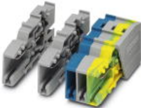
Kupplung, Anschlussart: Zugfederanschluss, Polzahl: 1, Querschnitt: 0,08 mm 2 - 4 mm 2 , AWG: 28 - 12, Breite: 5,2 mm, Höhe: 21,8 mm, Farbe: grau, Montageart: auf Montageplatte
