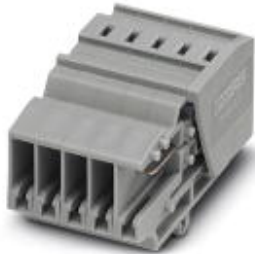
Kupplung, Anschlussart: Zugfederanschluss, Polzahl: 7, Querschnitt: 0,08 mm 2 - 4 mm 2 , AWG: 28 - 12, Breite: 36,4 mm, Höhe: 21,8 mm, Farbe: grau, Montageart: auf Montageplatte
