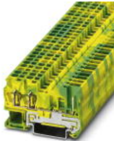
Schutzleiter-Reihenklemme, Anschlussart: Zugfeder- / Steckanschluss, Querschnitt: 0,08 mm 2 - 4 mm 2 , AWG: 28 - 12, Breite: 5,2 mm, Farbe: grün-gelb, Montageart: NS 35/7,5, NS 35/15
