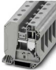
Durchgangsklemme, Anschlussart: Schraubanschluss, Querschnitt: 1,5 mm 2 - 50 mm 2 , AWG: 16 - 1/0, Breite: 16 mm, Höhe: 65,1 mm, Farbe: grau, Montageart: NS 35/7,5, NS 35/15
