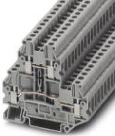
Doppelstock-Klemme, Querschnitt: 0,14 mm<sup>2</sup> - 4 mm<sup>2</sup>, AWG: 26 - 12, Anschlussart: Schraubanschluss, Breite: 5,2 mm, Farbe: grau, Montageart: NS 35/7,5, NS 35/15
