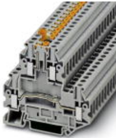
Messer-Trennklemme, Querschnitt: 0,14 mm 2 - 6 mm 2 , AWG: 26 - 10, Anschlussart: Schraubanschluss, Breite: 6,2 mm, Farbe: grau, Montageart: NS 35/7,5, NS 35/15
