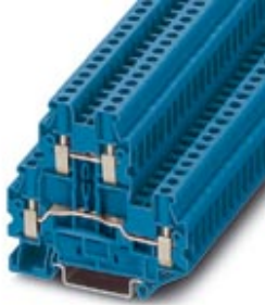
Doppelstock-Klemme mit Schraub-Anschluss, Querschnitt: 0,14 mm 2 - 6 mm 2 , AWG: 26 - 10, Breite: 6,2 mm, Farbe: blau
