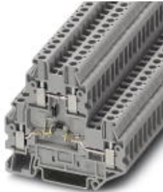
Bauelementreihenklemme, Querschnitt: 0,14 mm 2 - 4 mm 2 , AWG: 26 - 12, Anschlussart: Schraubanschluss, Breite: 5,2 mm, Farbe: grau, Montageart: NS 35/7,5, NS 35/15
