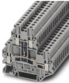
Doppelstock-Klemme mit Schraubanschluss, Querschnitt: 0,14 mm 2 - 6 mm 2 , AWG: 26 - 10, Breite: 6,2 mm, Farbe: grau
