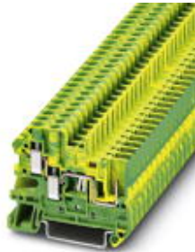
Schutzleiter-Reihenklemme, Anschlussart: Schraub- / Steckanschluss, Querschnitt: 0,14 mm 2 - 6 mm 2 , AWG: 26 - 10, Breite: 6,2 mm, Farbe: grün-gelb, Montageart: NS 35/7,5, NS 35/15
