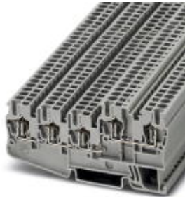
Initiatoren-/Aktorenklemme, Anschlussart: Zugfederanschluss, Querschnitt: 0,08 mm 2 - 4 mm 2 , AWG: 28 - 12, Breite: 5,2 mm, Farbe: grau, Montageart: NS 35/7,5, NS 35/15
