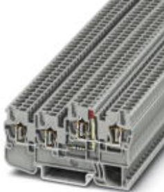
Initiatoren-/Aktorenklemme, Anschlussart: Zugfederanschluss, Querschnitt: 0,08 mm 2 - 4 mm 2 , AWG: 28 - 12, Breite: 5,2 mm, Farbe: grau, Montageart: NS 35/7,5, NS 35/15
