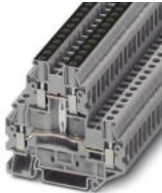
Bauelementreihenklemme, Querschnitt: 0,14 mm 2 - 6 mm 2 , AWG: 26 - 10, Anschlussart: Schraubanschluss, Breite: 6,2 mm, Farbe: grau, Montageart: NS 35/7,5, NS 35/15
