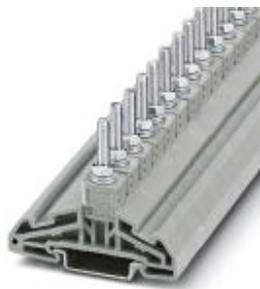
Hochstrom-Verbinder, Anschlussart: Bolzenanschluss, Querschnitt: 0,1 mm<sup>2</sup> - 16 mm<sup>2</sup>, AWG: 24 - 6, Breite: 13 mm, Höhe: 55,5 mm, Farbe: grau, Montageart: NS 35/7,5, NS 35/15
