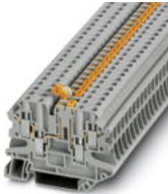
Messer-Trennklemme, Anschlussart: Schraubanschluss, Querschnitt: 0,14 mm 2 - 6 mm 2 , AWG: 26 - 10, Breite: 6,2 mm, Farbe: grau, Montageart: NS 35/7,5, NS 35/15
