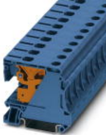
N-Trennklemme, Schraubanschluss, Querschnitt: 6 mm 2 - 25 mm 2 , AWG: 10 - 4, Breite: 12,2 mm, Farbe: blau, Montageart: NS 35/7,5, NS 35/15
