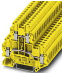
Doppelstock-Klemme mit Schraub-Anschluss, Querschnitt: 0,14 mm 2 - 6 mm 2 , AWG: 26 - 10, Breite: 6,2 mm, Farbe: gelb
