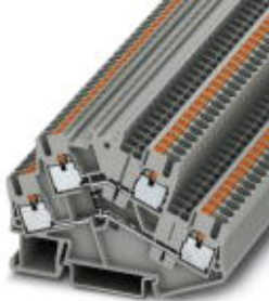
Bauelementreihenklemme, Anschlussart: Push-in-Anschluss, Querschnitt: 0,14 mm 2 - 4 mm 2 , AWG: 26 - 12, Breite: 5,2 mm, Farbe: grau, Montageart: NS 35/7,5, NS 35/15
