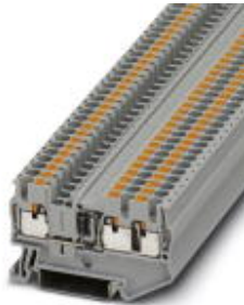
Bauelementreihenklemme, Anschlussart: Push-in-Anschluss, Querschnitt: 0,14 mm 2 - 4 mm 2 , AWG: 26 - 12, Breite: 5,2 mm, Farbe: grau, Montageart: NS 35/7,5, NS 35/15
