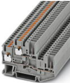
Doppelstock-Klemme, Querschnitt: 0,14 mm 2 - 4 mm 2 , AWG: 26 - 12, Anschlussart: Push-in- / Steckanschluss, Breite: 5,2 mm, Farbe: grau, Montageart: NS 35/7,5, NS 35/15
