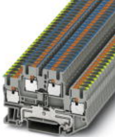
Schutzleiter-Doppelstockklemme, Querschnitt: 0,14 mm 2 - 4 mm 2 , AWG: 26 - 12, Anschlussart: Push-in-Anschluss, Breite: 5,2 mm, Farbe: grau, Montageart: NS 35/7,5, NS 35/15
