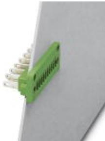
Steckerteil, Nennstrom: 8 A, Bemessungsspannung (III/2): 160 V, Polzahl: 14, Rastermaß: 3,81 mm, Anschlussart: Löt-/Flachsteckanschluss, Farbe: grün, Kontaktoberfläche: Zinn, Montage: Direktmontage
