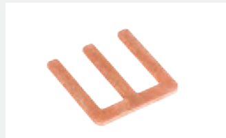
Brücke, 3-polig, BR/3-3.5/3.81-L7.5 Art.-Nr.: 50000000016 Unisolierte Brücke für den Leitersteckbereich. Verwendbar für Anschlussklemmen und Steckverbinder mit Rastermaß 3.5 mm und 3.81 mm.
