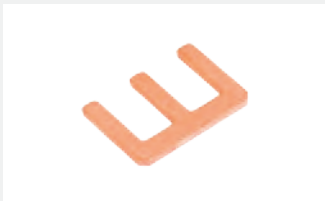
Brücke, 3-polig, BR/3-3.5/3.81-L4.7 Art.-Nr.: 50000000014 Unisolierte Brücke für den Leitersteckbereich. Verwendbar für Anschlussklemmen und Steckverbinder mit Rastermaß 3.5 mm und 3.81 mm.
