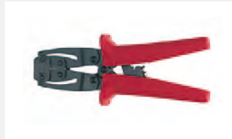
Crimpzange PZU 6 Art.-Nr.: 41100.0 Zur Verdrähtung von mehrdrähtigen und flexiblen Leitern mit Aderendhülsen in einem Querschnittsbereich von 0.14 mm 2 bis 6.0 mm 2 .
