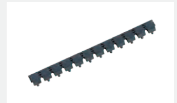
Kodierabdeckung CC-AK1350-GRAU Art.-Nr.: 51350000000 Wird von oben/schraubseitig auf den Stecker eingerastet. Die Kodierabdeckung verhindert ein um 180° verdrehtes Aufstecken der AK1350 auf die Stiftleiste.
