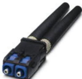
LWL-Steckverbinder SCRJ, IP20, duplex, mit Schnellanschlusstechnik, für Polymerfaser 980/1000 µm, für Einzeladerdurchmesser 2,2 mm
