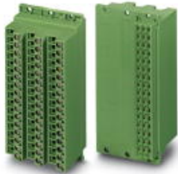
Schraub-Federleiste, Nennstrom: 4 A, Polzahl: 48, Rastermaß: 0 mm, Anschlussart: Schraubanschluss, Farbe: grün, Kontaktoberfläche: Zinn
