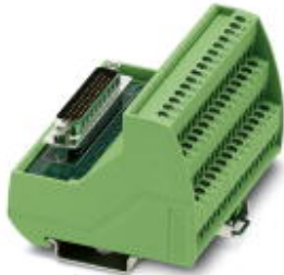
VARIOFACE-Modul, mit Schraubanschluss und High-Density-D-SUB-Miniatur-Buchsenleiste, zur Montage auf NS 35, Polzahl: 15, Breite: 44,9 mm
