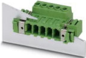
Steckerteil, Nennstrom: 41 A, Bemessungsspannung (III/2): 1000 V, Polzahl: 3, Rastermaß: 7,62 mm, Anschlussart: Schraubanschluss, Farbe: grün, Kontaktoberfläche: Zinn
