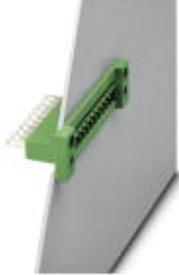
Steckerteil, Nennstrom: 12 A, Bemessungsspannung (III/2): 320 V, Polzahl: 16, Rastermaß: 5,08 mm, Anschlussart: Löt-/Flachsteckanschluss, Farbe: grün, Kontaktoberfläche: Zinn, Montage: Direktmontage, Das Zubehörteil Art.-Nr. 5030172 ist nur in Verbindung mit MSTB 2,5/...ST-5,08 und MSTBT 2,5/...ST-5,08 verwendbar.
