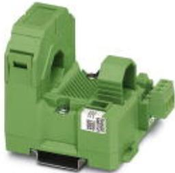
MCR-Strommessumformer, zur Messung von sinus- und nicht sinusförmigen Wechselströmen, Eingangsstrom 0...400 A, Ausgangsspannung 0...(5) 10 V
