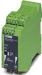
LWL-Konverter mit integrierter optischer Diagnose, Alarmkontakt, für RS-485 2-Draht-Bussysteme (SUCONET K, Modbus ...) bis 500 kBit/s, NRZ-Kodierung, T-Koppler mit zwei LWL-Schnittstellen (FSMA), 660 nm, für Polymer-/HCS-Faserkabel
