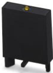
Steckmodul, zur Montage auf PR3, mit Freilaufdiode und LED gelb, Polarität: A1+, A2-, Eingangsspannung: 12-24 V DC  $\pm$  20%
