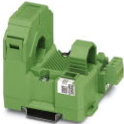
MCR-Strommessumformer, zur Messung von sinus- und nicht sinusförmigen Wechselströmen, Eingangsstrom 0...200 A, Ausgangsspannung 0...(5) 10 V
