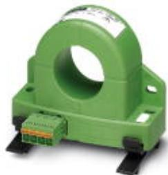
Universalstrommessumformer, zur Messung von Gleich-, Wechsel- und verzerrten Strömen, Eingangsstrom 0 ... 400 A, Ausgang 4 ... 20 mA
