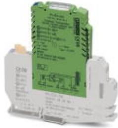
Ex-i Analog Eingang: Eingangstrennverstärker, HART. Überträgt 4-20 mA Signale von im Ex-Bereich installierten, fremdgespeisten Messumformern zu einer Bürde im sicheren Bereich. Galvanische 3-Wege Trennung (Eingang / Ausgang / Versorgung).
