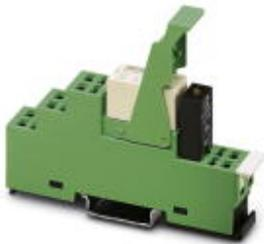
Vormontierte Relaismodule mit Zugfederanschluss, bestehend aus: Relaissockel, Mehrlagenkontaktrelais, steckbarem Anzeige-/ Entstörmodul und Haltebügel. Eingangsspannung: 24 V DC, 2 Wechsler, 8 A
