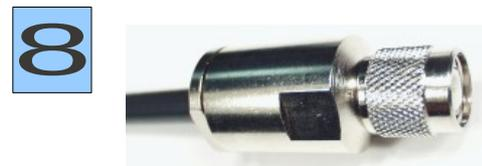
Das so vorbereitete Kabelende bis zum Anschlag in das Steckergehäuse einschieben. Mit zwei Maulschlüsseln 16 mm die Spannmutter handfest anziehen. Ein kleiner Spalt zwischen Spannmutter und Steckergehäuse sollte noch sichtbar sein!
