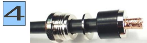
Kupfergeflecht im rechten Winkel hochbiegen. Kontakthülse zwischen Kupferfolie und Geflecht bis zum Anschlag einschieben. Überstehendes Geflecht abschneiden. Gummidichtung bis zur Kontakthülse nach vorne schieben.
