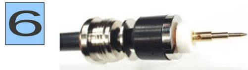
Teflonscheibe über Innenleiter schieben. Anschließend Innenstift aufstecken und durch das kleine Loch sorgfältig verlöten.
