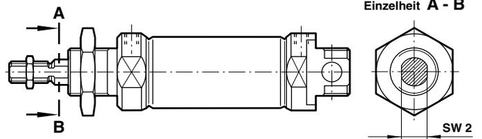
**RM/8000/JM – Zylinder mit durchgehender Kolbenstange**
