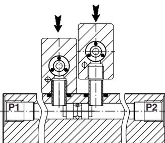
3. Montage der Ventile auf der Grundplatte (Buchsen ragen in die Anschlussgewinde).
