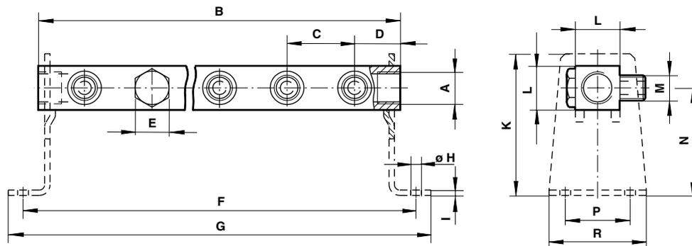
Bei gleichzeitigem Schalten von mehr als 4 Ventilen Zulauf P beidseitig wählen.
