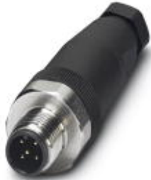
Sensor-/Aktor-Stecker, Stecker, gerade, 5-polig, M12, Schraubanschluss, Edelstahlrändel, Kabelverschraubung Pg7
