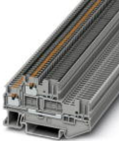
Doppelstock-Klemme, Querschnitt: 0,14 mm 2 - 1,5 mm 2 , AWG: 26 - 14, Anschlussart: Push-in- / Steckanschluss, Breite: 3,5 mm, Farbe: grau, Montageart: NS 35/7,5, NS 35/15
