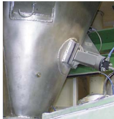
Abreinigen von Bunkerwänden
